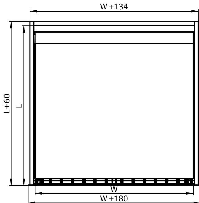
На данном эскизе изображена электрогидравлическая уравнивательная платформа с поворотной аппаратурой подвешенного типа шириной 2000 мм, длиной 2000 мм, высотой 600 мм.
