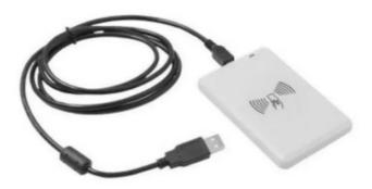
Для начала работы с USB считывателем подключите его к персональном компьютеру через разъем USB. Подключитесь локально или удаленно к модулю ДОМОВОЙ IP и в разделе сервис выберите порт, к которому подключен USB считыватель.
