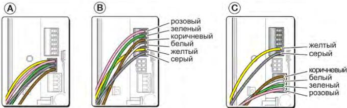
Если вы используете кабель двигателя Nice, концевые выключатели подключаются следующим образом:
