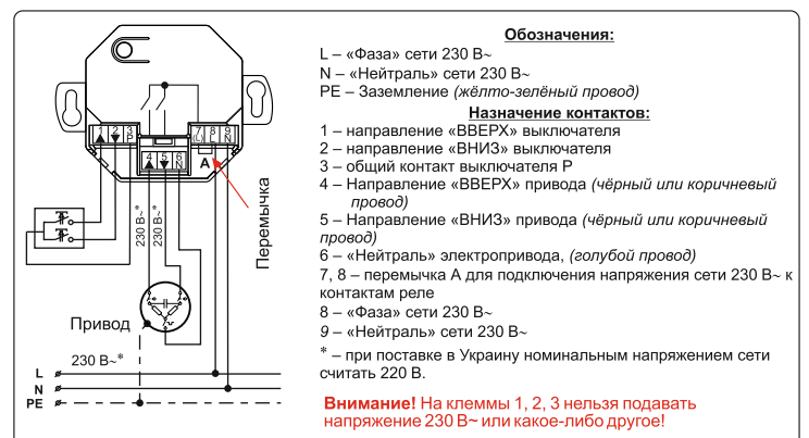
Рисунок 2 – Типовая схема подключения Nero 8013UPM и назначение контактов
